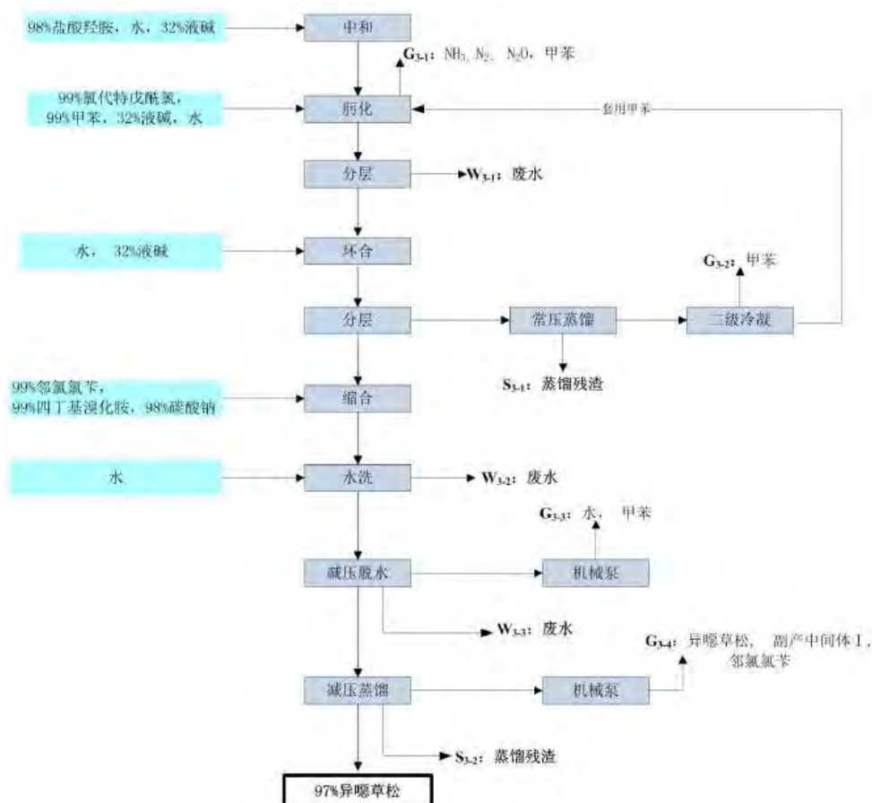
图 4.3-10 异噁草松生产工艺流程图
