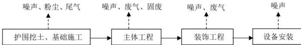
图 2-3 施工期施工流程及产污环节简图
