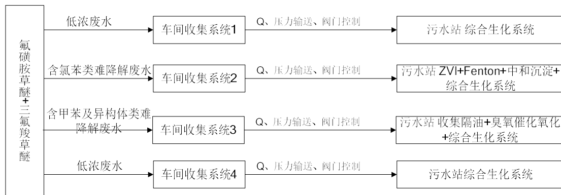
图 4.5.2-4 107 车间废水分类收集示意图
