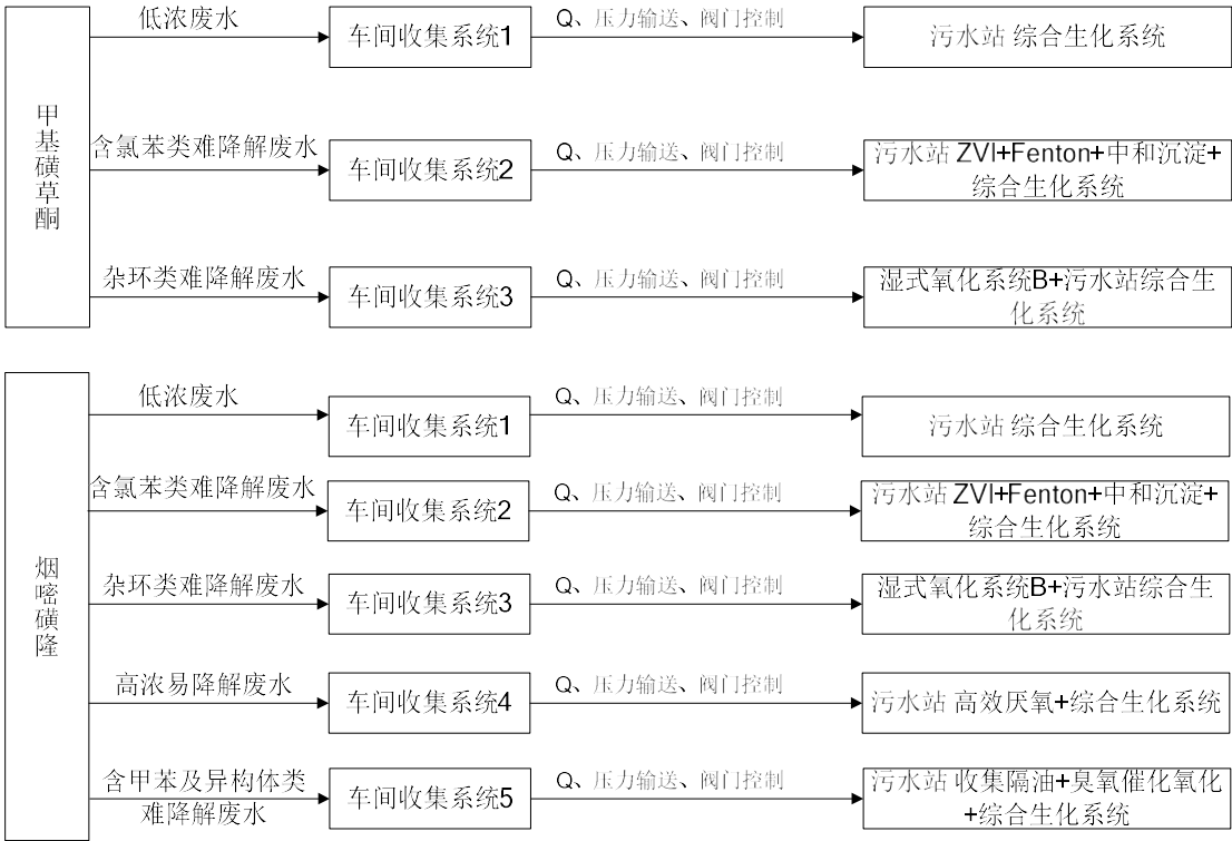
图 4.5.2-7 112 车间废水分类收集示意图（车间尚未建设）
