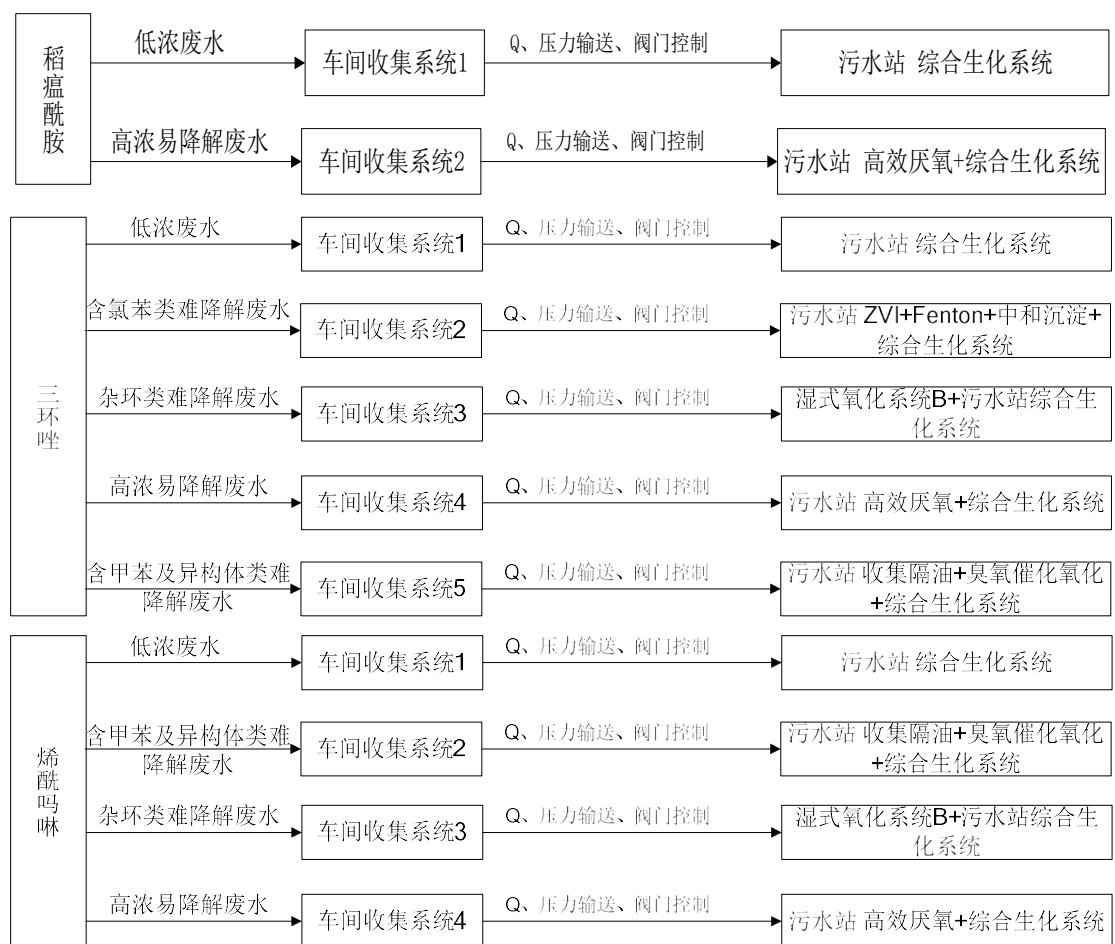
图 4.5.2-3 106 车间废水分类收集示意图（烯酰吗啉尚未投产）
