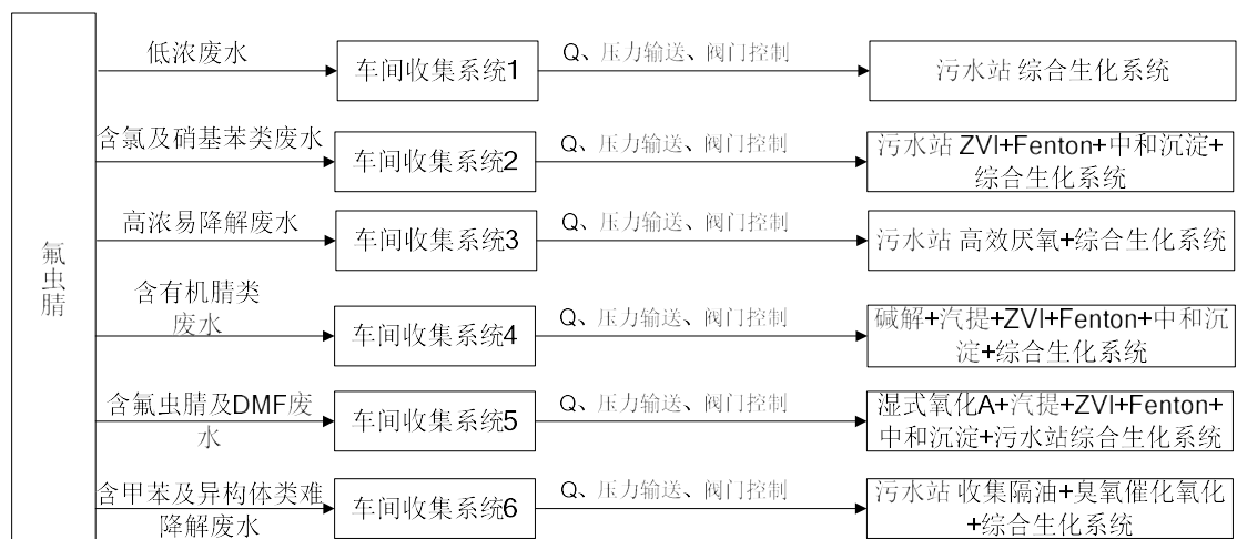
图 4.5.2-2 104 车间废水分类收集示意图
